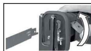
2. Insira a lâmina de serra o máximo possível ou remova-a (Fig. C).
